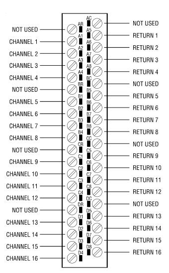
Fig 1. 2590-EF/2591-EF Connector Pin Out
