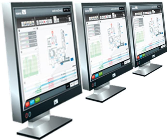
Chaque PC zenon<sup>®</sup> est équipé de trois écrans LCD 22 pouces pour permettre aux opérateurs d'afficher simultanément plusieurs vues (synoptique process, listes des alarmes, courbes...)
